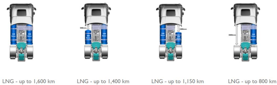
Fig. 1. 17 LNG tank configuration on vehicle layout
